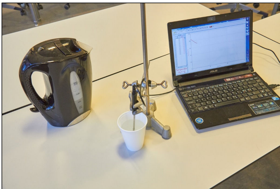
Forsøg: Newtons afkølingslov afprøves
